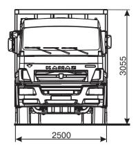
Размеры даны для автомобиля снаряженной массы
